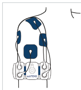
4 électrodes = 4 câbles Canal 1 et canal 2
